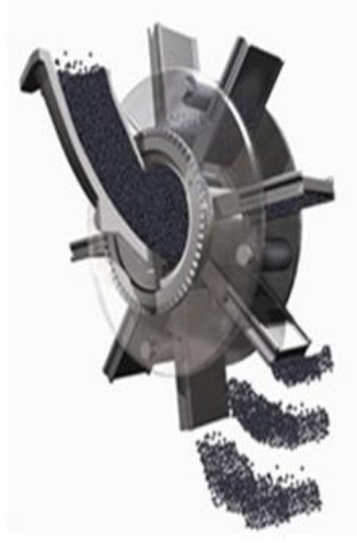
شکل ۱: روش توربین چرخنده در پرتاب مواد ساینده و اجزای بازیابی در یک دستگاه شات بلاست
