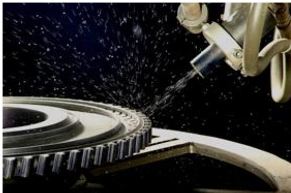
شکل ۱: فرآیند شات پینینگ چرخدنده (روش Air blast)
