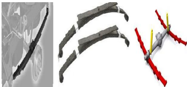
شکل ۱۱: کاربرد فنرهای تخت در سیستم تعلیق خودرو اهرم تعلیق خودرو (تورشن بار)
