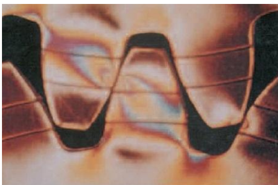
شکل ۵: نمای پلاریزه از تنشهای اعمال شده بر روی دندانههای درگیر در یک چرخ دنده
