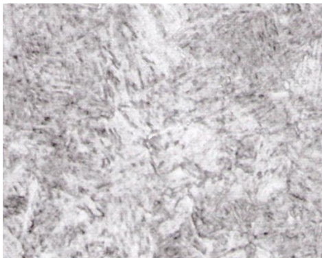
شکل ۶: ریزساختار بینایتی در ساچمه های کم کربن
