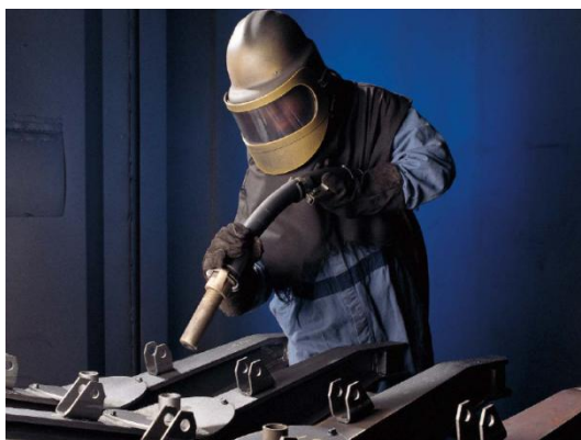
شکل ۱: روشهای پاشش مواد ساینده الف: روش توربینی چرخنده ب: نازل با فشار بالای هوا
