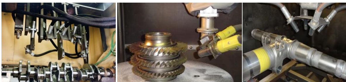
شکل ۴: نازل‌های فرایند شات پینینگ برای قطعات مختلف خودرو
